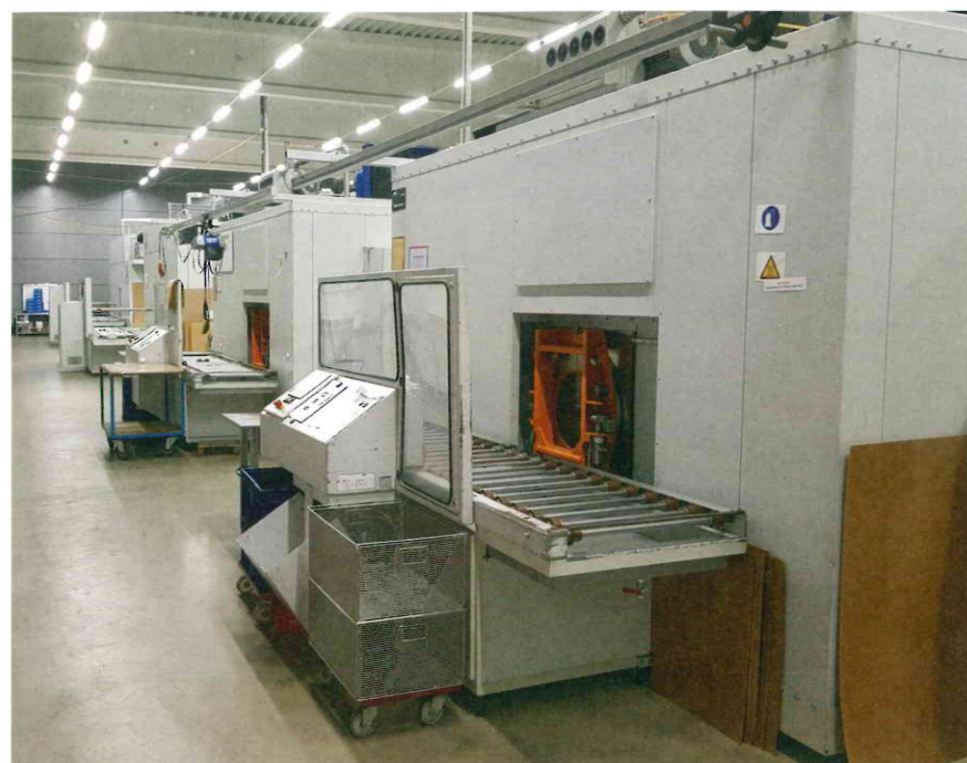
Um die hohen Sauberkeitsanforderungen zu erfüllen, setzt der Lohnreiniger drei Lösemittel- und eine Hybridanlage ein. Die Reinigungsprozesse erfolgen mit modifiziertem Alkohol.
