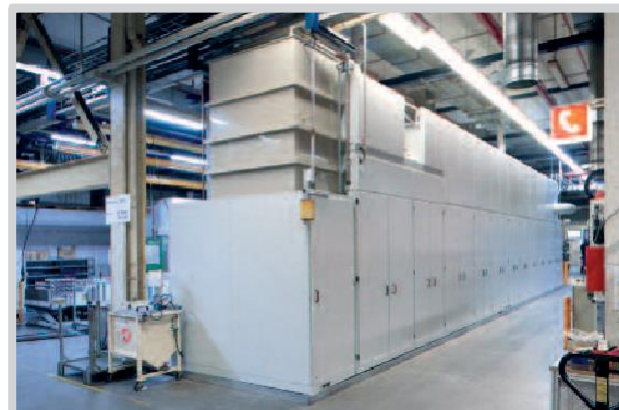
带溶剂清洗腔的多腔浸没清洗设备
