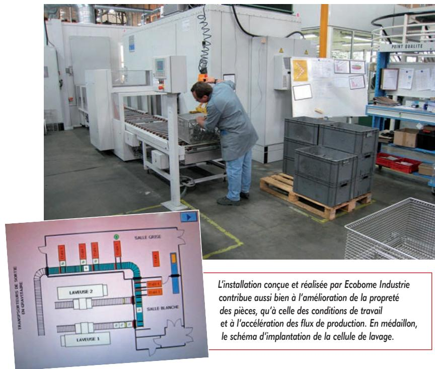
L'installation conçue et réalisée par Ecobome Industrie contribue aussi bien à l'amélioration de la propreté des pièces, qu'à celle des conditions de travail et à l'accélération des flux de production. En médaillon, le schéma d'implantation de la cellule de lavage.
